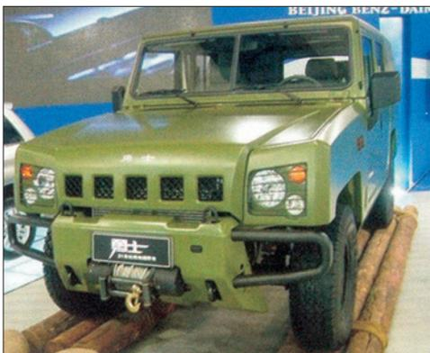
3,5 л, который развивает мощность 135 л. с., и обеспечивает максимальную скорость движения по шоссе 90 км/ч. Емкость топливного бака 103 л, при этом запас хода по шоссе составляет 1 000 км. Автомобиль рассчитан на эксплуатацию в условиях низких температур, а также высокогорья.
