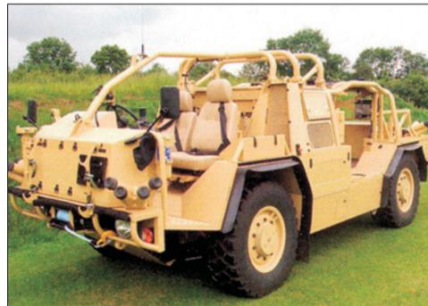
На автомобиле установлен дизель мощностью 180 л. с., который позволяет двигаться по шоссе со скоростью до 130 км/ч. Он может оснащаться различным вооружением, в том числе автоматической пушкой или пулеметом калибра 12,7 или 7,62 мм.
