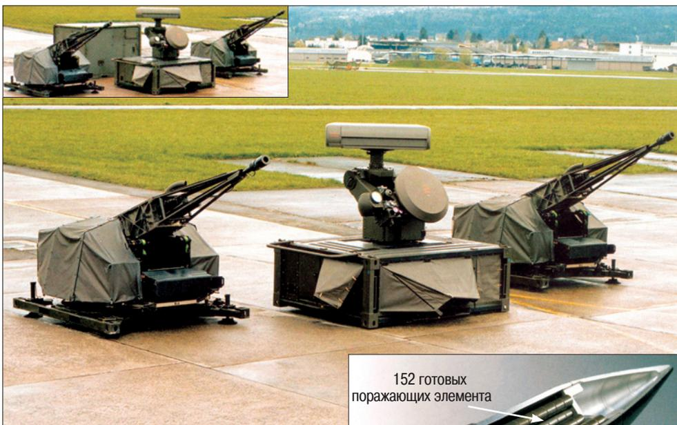
*Зенитный артиллерийский комплекс ближнего действия «Скайшилд-АНЕАД» и макет снаряда АНЕАД*
